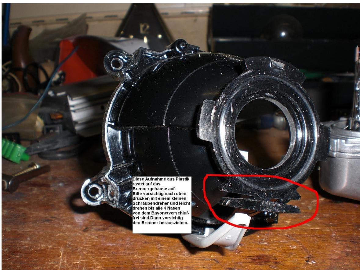
Hier rastet der Scheinwerfer auf das Brennergehäuse ein. Also kleinen Schraubendreher nehmen und vorsichtig anhebeln bis sich der Brenner wieder drehen lässt.
